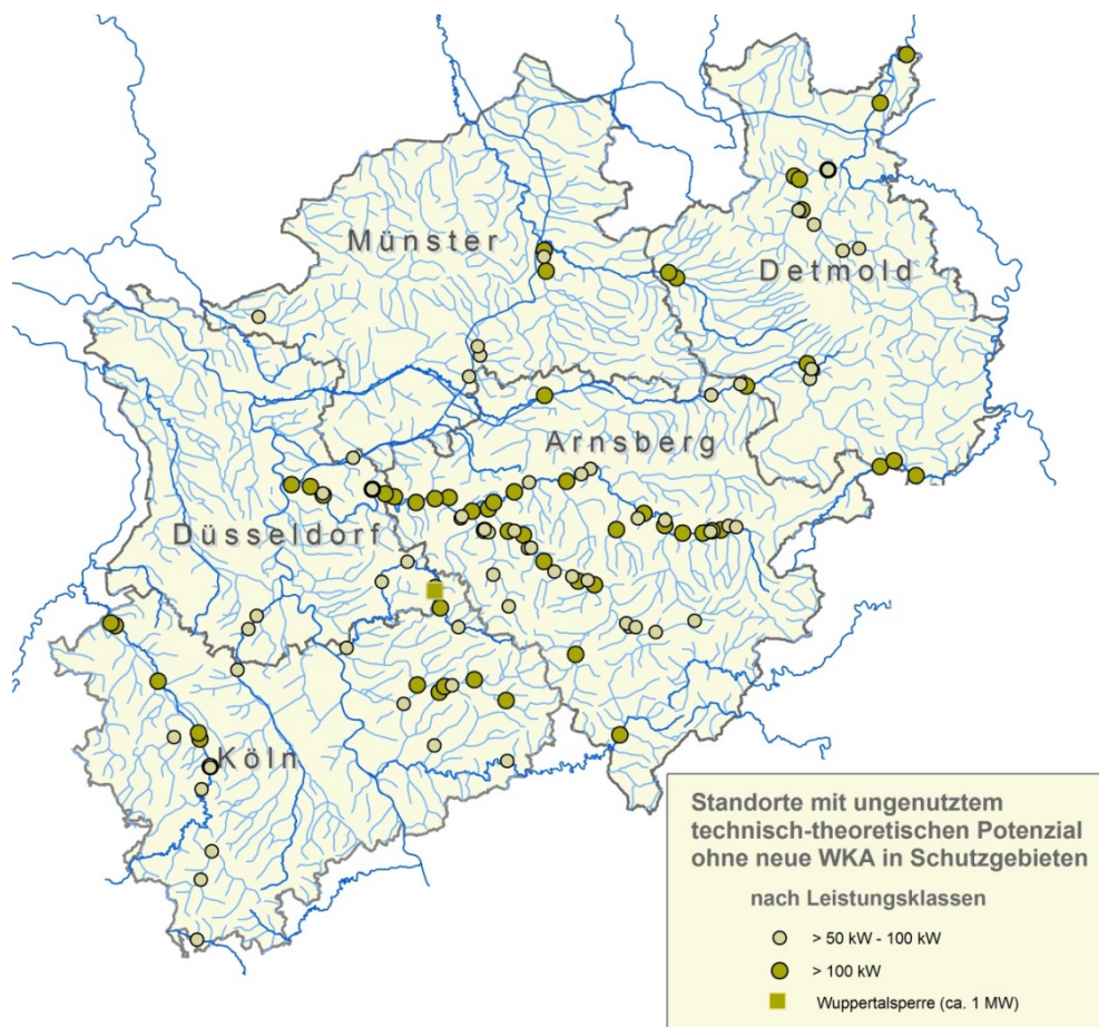
Abbildung 19: Standorte potenzieller Wasserkraftanlagen nach Leistungsklassen (maximales Szenario)
